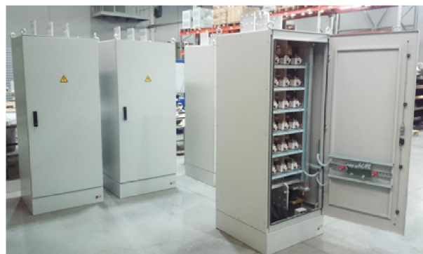
Тиристорные выпрямители 6.3кА/450В с водяным охлаждением (в составе агрегата 25кА)
