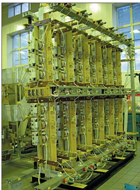
Рис. 3. Тиристорный выпрямительный блок 40 кА, 1000 В
